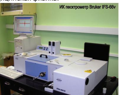
Несмотря на то, что в настоящее время идет дооснащение центра необходимым оборудованием, в нем ведется интенсивная исследовательская деятельность. Из установленных приборов наиболее активно используются спектрометры. Например, ИК спектрометр IFS 66v, стоимостью несколько сот тысяч
