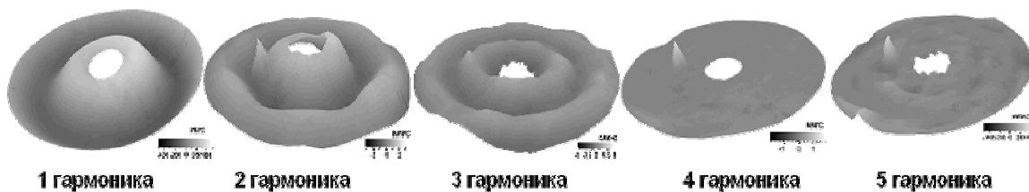
Рис. 2 Формы колебаний пластины на гармониках моды с резонансной частотой 2,5 кГц
