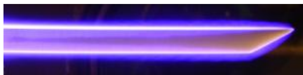
Рис. 2. Разряд на поверхности диэлектрической антенны. Давление воздуха P=40 Торр, длительность импульса СВЧ \tau=100 мкс, мощность СВЧ волны W_{и}=40 кВт, поперечные размеры антенны 0.8 \times 2.4 см 2 [3].
