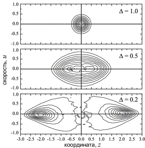
Рис. 2. Контурный вид функции распределения параметров системы в зависимости от эффективности динамической ловушки. ( $\sigma = \xi = 0.1$ )
