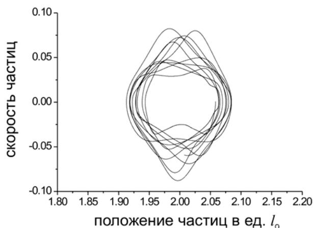
Рис. 9. Пример странного аттрактора одной частицы в отсутствие шума.
