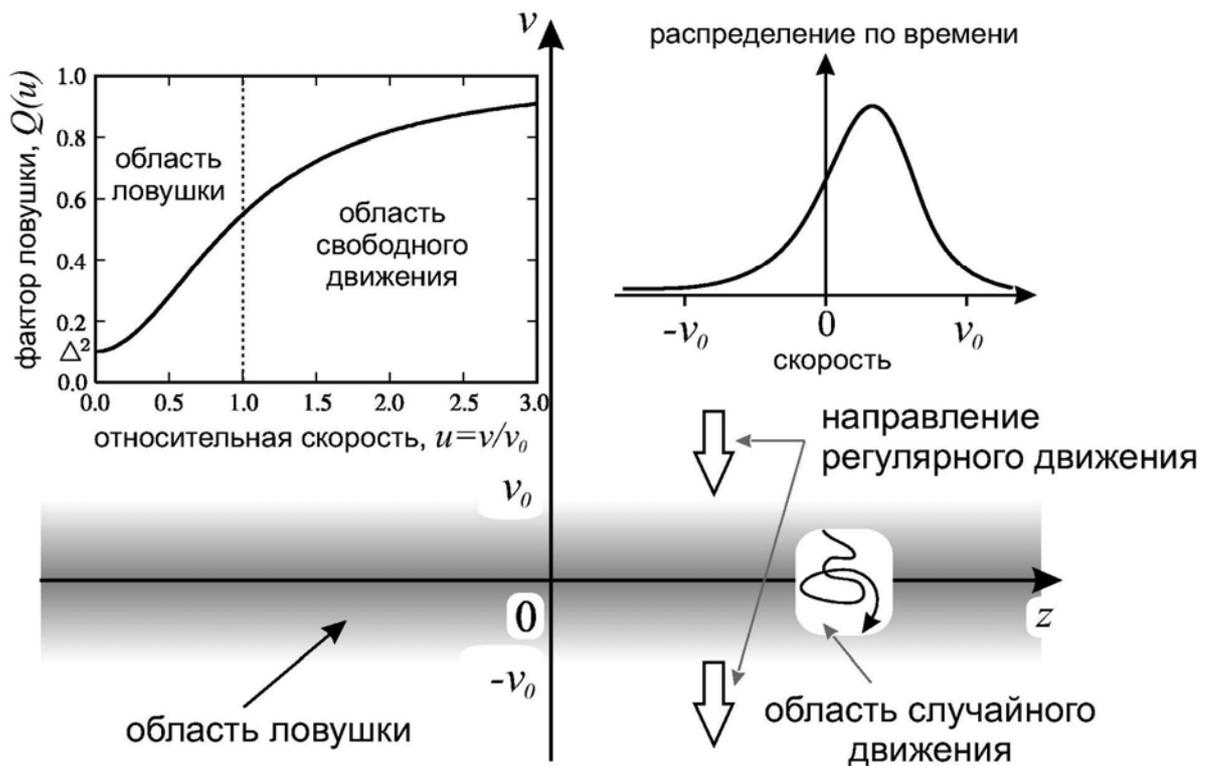
Рис. 1. Область динамической ловушки (ОДЛ) в фазовом пространстве (затемнение). При небольшой скорости частицы регулярная сила подавлена и движение носит в большей степени случайных характер. В ОДЛ распределение скорости асимметрично, из-за чего возникает накачка энергии в осциллятор.
