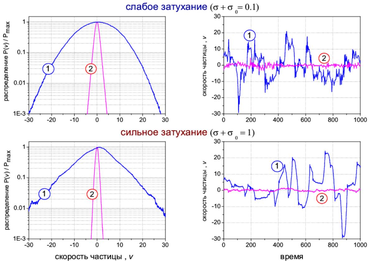
Рис. 7. Функция распределения скорости совокупного ансамбля частиц (кроме граничных) при сильном и слабом затухании, а также при 1 — низкой ( $l=50$ ) и 2 — высокой плотности частиц ( $l=5$ ). Справа приведен фрагмент движения одной частицы после возникновения неустойчивости.
