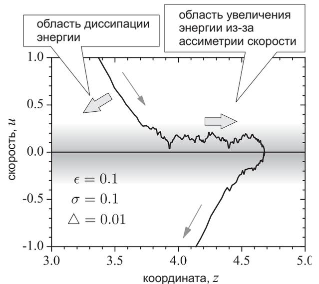
Рис. 3. Фрагмент траектории частицы при прохождении области динамической ловушки. Большими стрелками указано направление действия силы.
