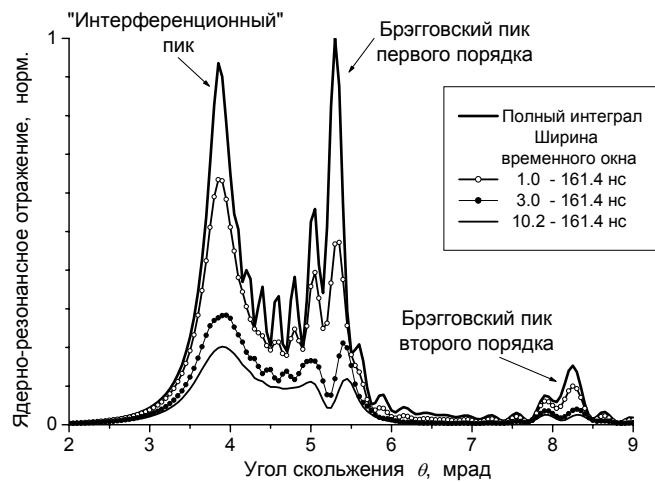
Рис. 2. Кривые ядерно-резонансного отражения в зависимости от ширины временного окна регистрации задержанного по времени сигнала, рассчитанные для структуры [^{56}\text{Fe}/^{57}\text{Fe}]_{10} .
