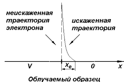
Рис. 2. Иллюстрация к соотношению (1). Половина поверхности заряжена до потенциала V , у второй половины потенциал — нулевой. В результате воздействия заряженной области траектория электрона искажается. Если V < 0 , то электрон отталкивается (как на рисунке); если V > 0 , то он притягивается
