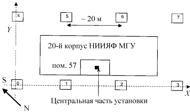
Рис. 1. Расположение детекторных пунктов прототипа установки ШАЛ-1000
