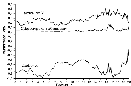
Рис. 1. Динамика aberrаций, измеренных в течение 20 с (для наклона, дефокуса и сферической aberrаций)
